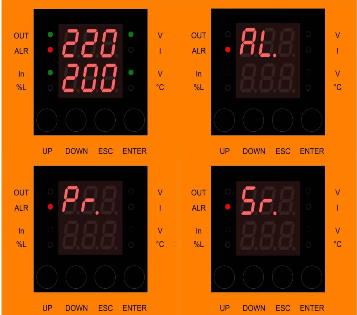
Resim 2.10 : Alarm Durumunda Tüm Menülerde Alarm Ledi Aktif
